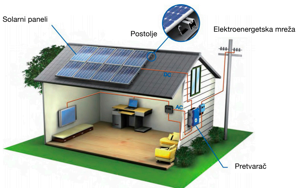
Slika 4. Integrirani fotonaponski sustav (4)
